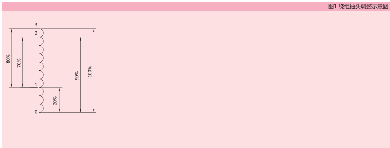
图1 绕组抽头调整示意图
